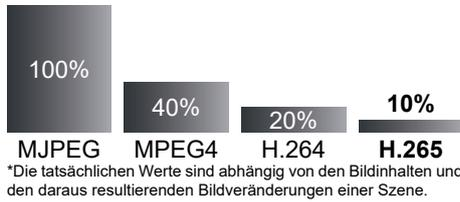
Komprimierungsverfahren verringern den Datenverkehr auf dem Netzwerk und erhöhen gleichzeitig die Aufzeichnungsdauer.
